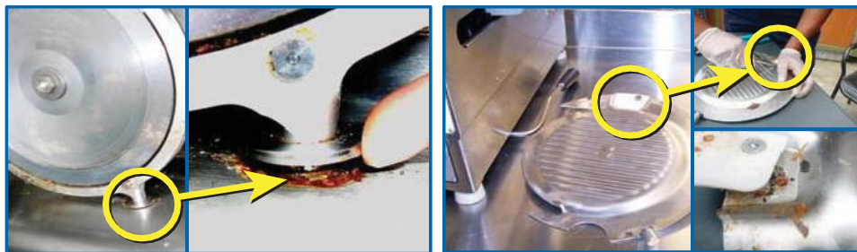
Acumulación de restos de alimentos en el montaje del protector del anillo.
